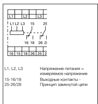
Схема подключения CM-MPN.x2
