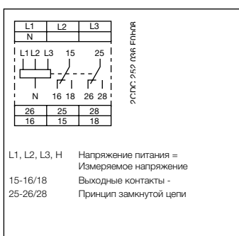
Схема подключения CM-UFS.2
