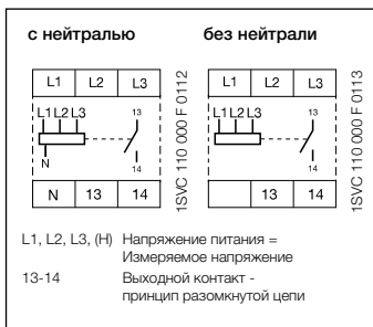
Схема подключения CM-PBE
