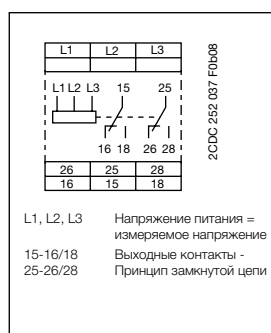
Схема подключения CM-PAS.x1
