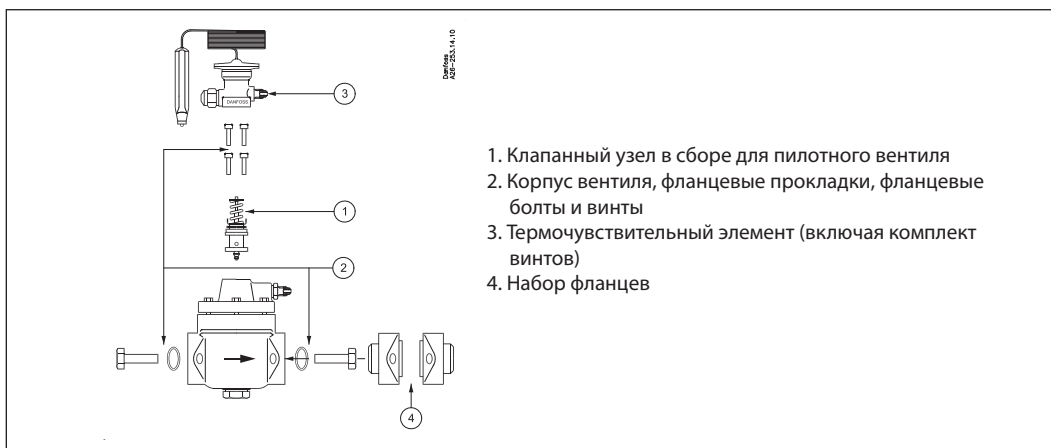
Вентиль PHT 85 с паяными или приварными фланцами
